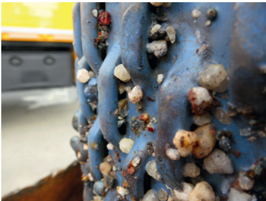
Abb. 3: Rückbau aufgrund irreversibel verstopfter Schlitz durch Unterkorn
